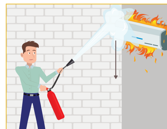
Палаючу рідину, що виливається з висоти, гасіть зверху донизу
