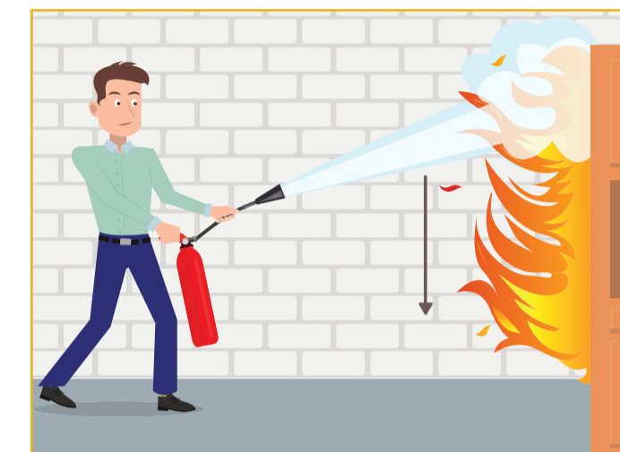
Якщо горить вертикальна поверхня, гасіть її зверху донизу
